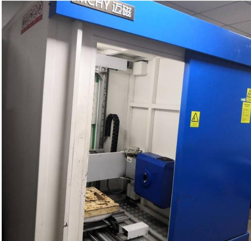
图 9-4 供应商提供的 X 射线探伤装置内部结构图
