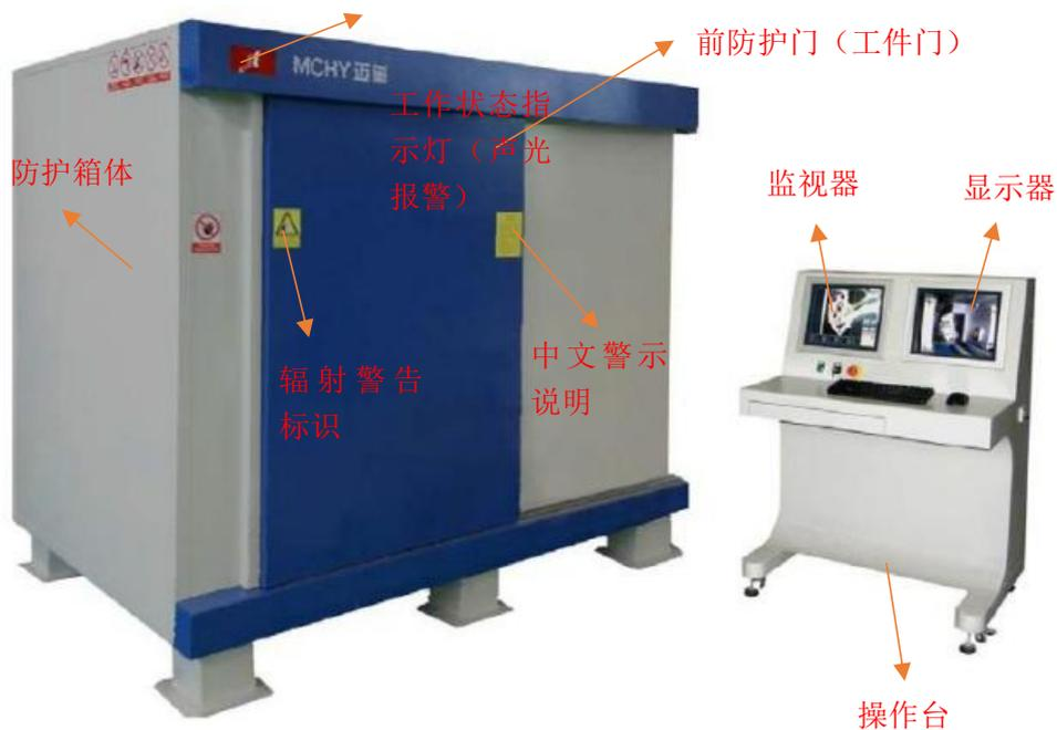
图 9-1 工业用 X 射线探伤装置外部示意图
